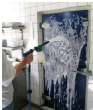
Mytí pěnou pomocí pistole AK-MNA02-BL s instalovaným vyvíječem pěny AK-TANKC01
