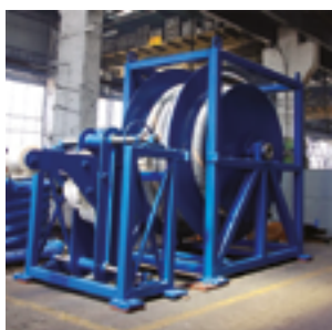
Buben pro vodní tryskačský systém (ang. jetting) - plovoucí jednotka (HLJV) pro stavbu a provoz větrných elektráren.
